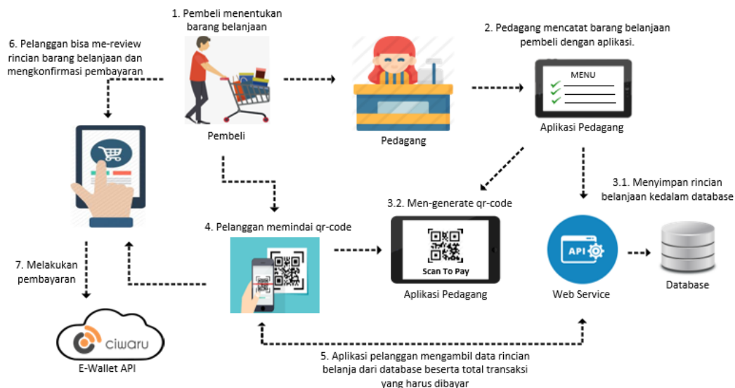
Gambaran Sistem Transaksi Prototipe sistem transaksi E-Wallet Pasar Tradisional
