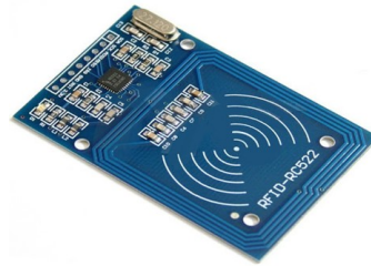
Gambar 3 Modul MFRC522
