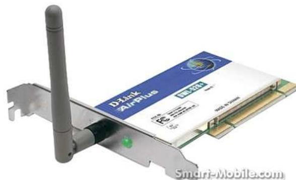
Perangkat ini berperan sebagai kartu jaringan nirkabel. Tersedia beberapa jenis WLAN Card sesuai dengan pilihan penempatannya pada komputer, antara lain PCI WLAN card, PCMCIA WLAN Card, USB WLAN Card, USB Add-on PCI Slot dan Mini PCI Bus Adapter.
