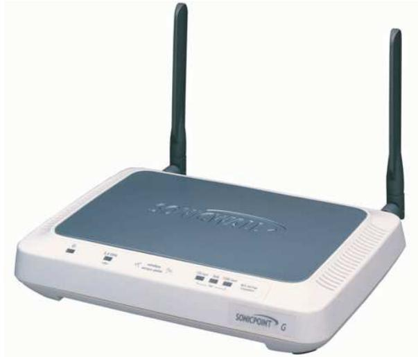
Mirip seperti hub yang menyatukan sebuah jaringan, perangkat *Access Point* menjadi sebuah pusat jaringan dengan memancarkan signal radio untuk diterima oleh komputer lain. *Access point* yang berdiri sendiri dengan antena dan adaptor power bisa difungsikan sebagai bridge dan router.
