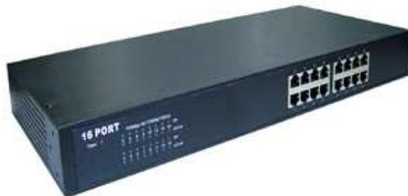
Hub atau concentrator berfungsi menghubungkan antar titik atau node sehingga terbentuk suatu jaringan. Hub juga berfungsi untuk mengatur lalu lintas data dari berbagai client dan mengontrol terjadinya gangguan dalam jaringan fisik.
