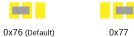
Gambar 11. Pengaturan Jumper Pemilihan Alamat I2C BME280
